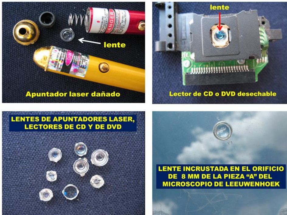
Figura 5. Apuntadores laser y lectores de CD y DVD dañados a partir der los cuales se obtuvieron lentes que producen aumentos desde 60x a 150X. estos lentes se incrustan en el orificio de la pieza "A".
