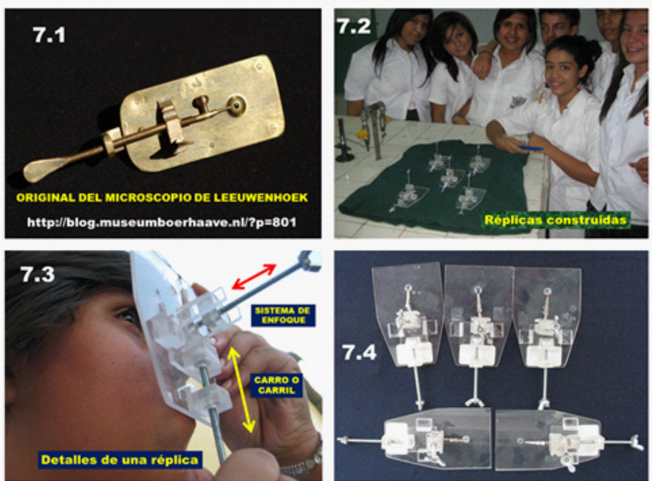
Figura 7. 7.1, 7.2, 7.3, 7.4. Comparación del microscopio original de Anton Van Leeuwenhoek y algunas de las réplicas construidas.
