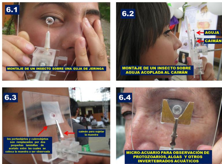
Figura 6. Cuatro sistemas para la preparación de las muestras a ser observadas a través del microscopio de Leeuwenhoek.
